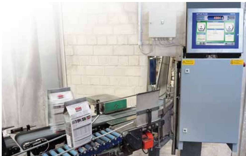
Pesage de sacs verticaux avec une trieuse pondérale XS40.
